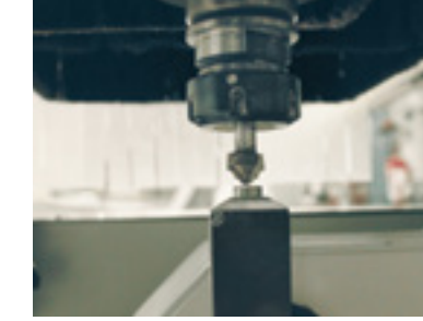
Auto Tool Length Measuring Probe (STD.) Oto. Takım boyu ölçme Probu (STD.)
